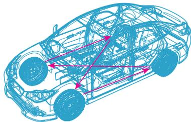
为了让轮胎均匀磨损并延长轮胎的使用寿命,我们建议每行驶 10 000 km 进行一次轮胎换位.
